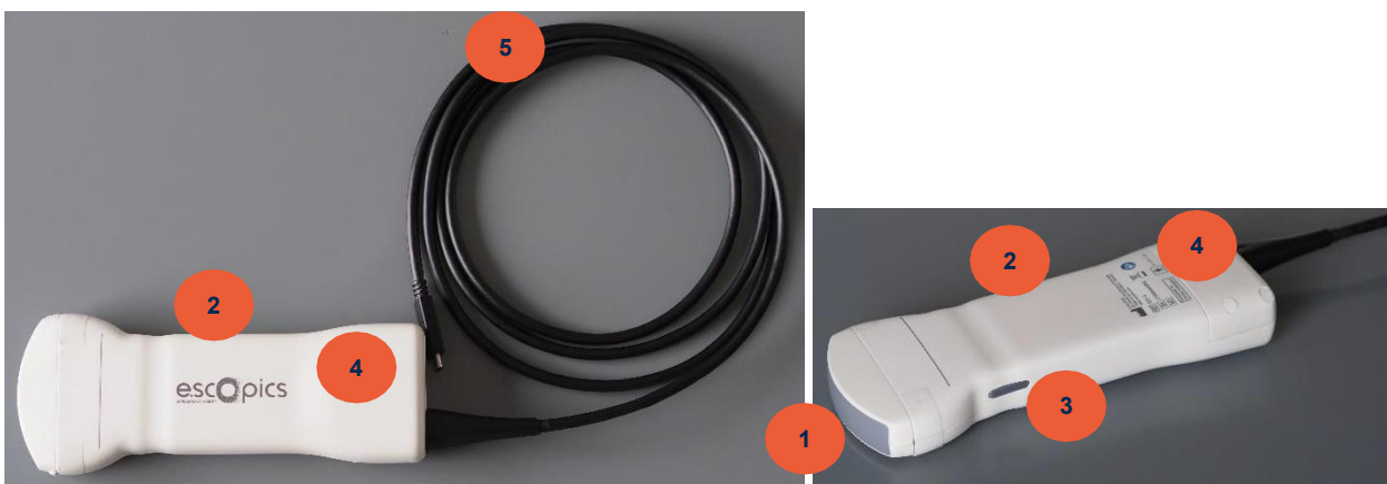
Figura 5. Imágenes de la sonda e.C5-1. 1: parte acústica de la sonda. 2: mango de la sonda. 3: botón de control ubicado en la sonda. 4: el vibrador electrodinámico está dentro de esta parte de la sonda; trampilla del vibrador en la imagen derecha. 5: Cable USB-C.
