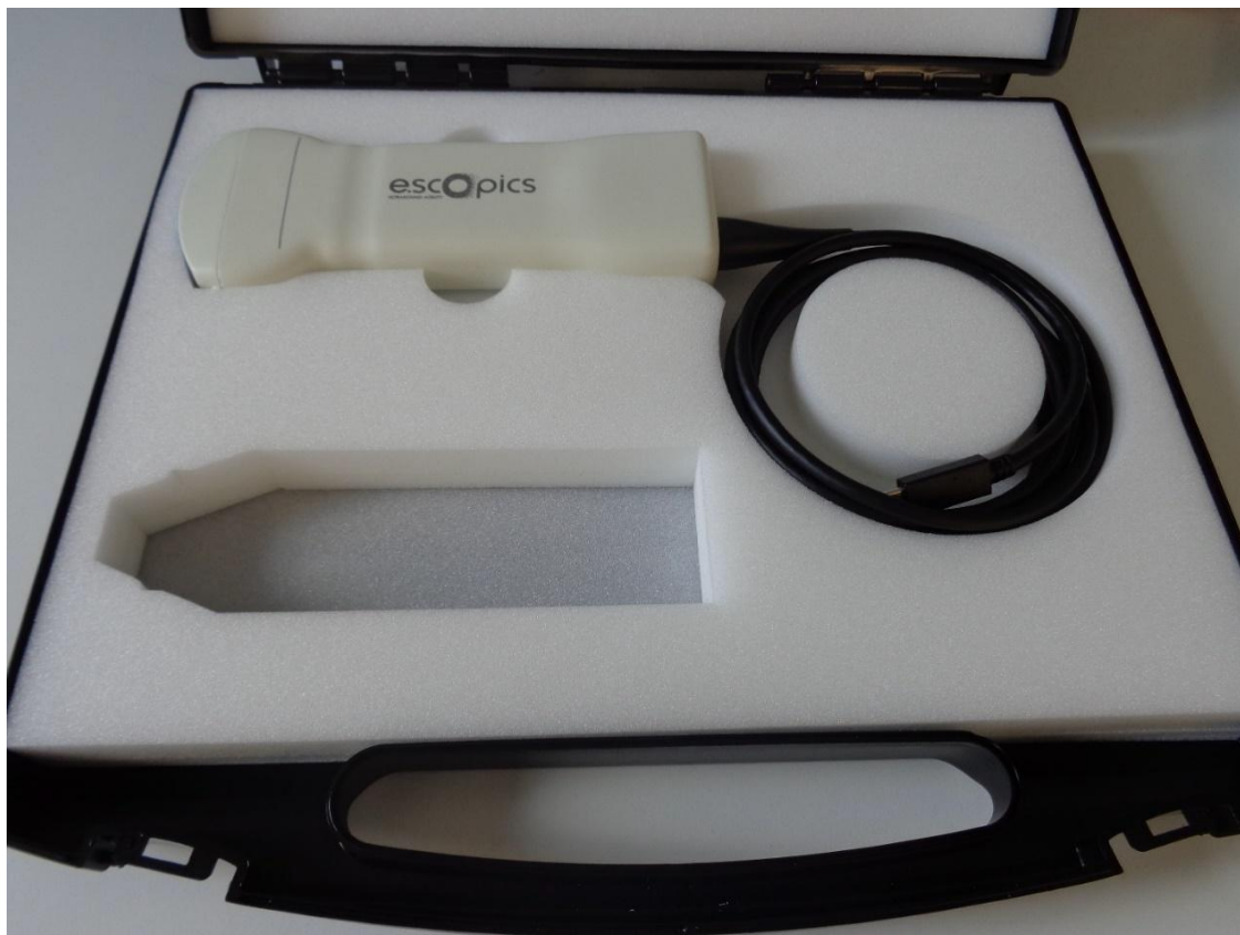
Figura 2. Fotografía de la sonda e.C5-1 en su estuche de transporte donde se muestra el lugar para una botella de gel para ecografías.
